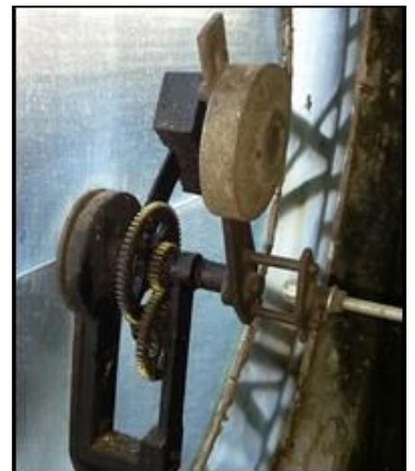
il vetro) c'è poi un ulteriore gruppo di ingranaggi che realizza il secondo movimento (partendo da quello trasmesso dal perno) demoltiplicato e collegato alla sfera delle ore le fa compiere un giro completo in 12 ore.
